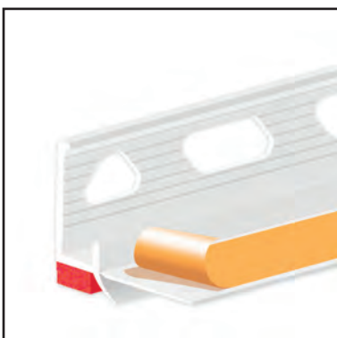
Anputzleiste mit elastischer Schutzlippe und gelochten Einputzschenkel für einlagige Innenputze. Zur RAL-konformen Fenstermontage bei Massivmauerwerk als Bestandteil des T-FAL® Dichtsystems.
