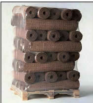
Stauss-Fassadengewebe ist ein Putzträger für erhöhte Leistungsanforderungen, bestehend aus einem Drahtgewebe mit aufgepressten und ziegelhart gebrannten Tonkreuzchen. Jede Rolle ist einzeln foliert.
